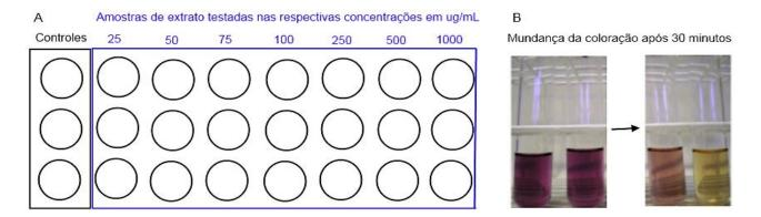
**Figura 1 -** A: Estrutura do teste DPPH, círculos representam tubos de ensaio; B: Mudança de coloração de roxo para uma coloração mais clara das soluções do teste DPPH após o período de 30 minutos devido à ação antioxidante neutralizando os radicais livres.
